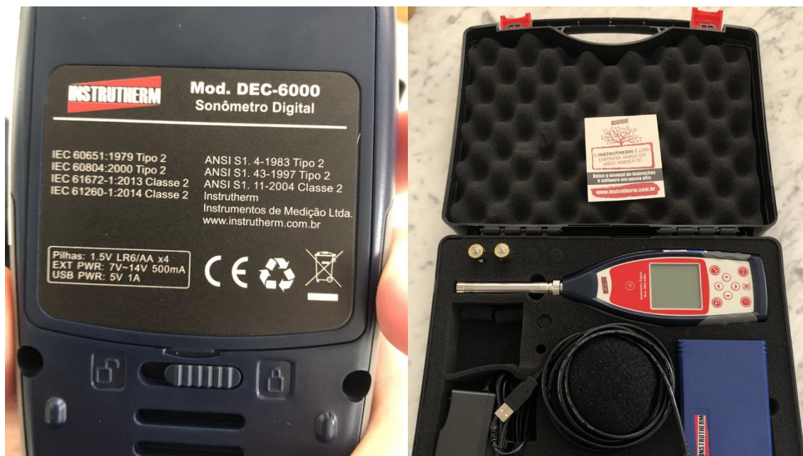
Figura 53. Sonômetro Digital DEC-6000, em atendimento as normas IEC 60651:1979, IEC 60804:2000, IEC 61672-1:2013 Classe 2 e IEC 61260-1:2014 Classe 2, ANSI S1. 4-1983 Tipo 2, ANSI S1. 43-1997 Tipo 2 e ANSI S1. 11-2004 Classe 2.
